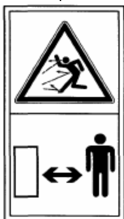
Рисунок 7.7 – Опасность выброса твердых предметов руслами приспособления. Находитесь на безопасном расстоянии от работающего приспособления.
