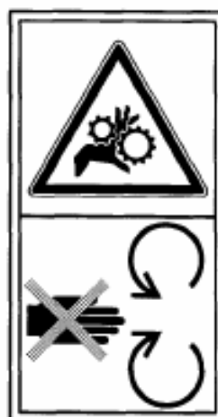
Рисунок 7.6 – Соблюдайте осторожность в опасной зоне. Избегайте соприкосновения любой части тела или одежды с движущимися элементами приспособления.
