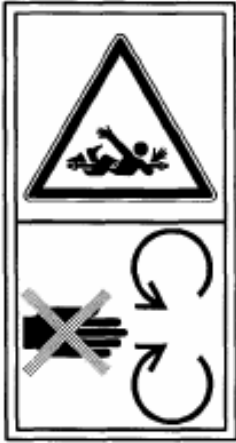
Рисунок 7.8 – Не допускайте соприкосновения любой части тела или одежды с карданными валами во время работы приспособления
