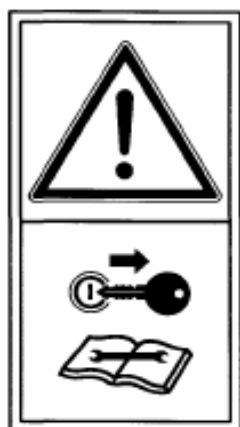
Рисунок 7.5 – Перед техобслуживанием и ремонтом выключите двигатель комбайна и извлеките стартовый ключ.
